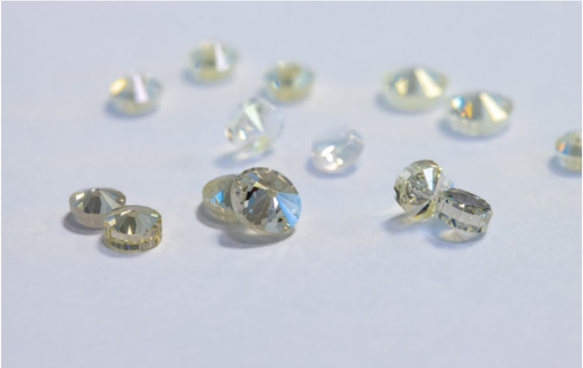
Speciaal technisch slijpsel: diamantaambeeld, Almax-easyLab , Diksmuide
