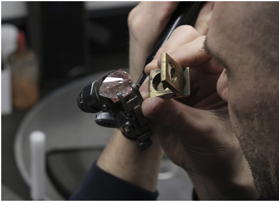
Controleren van het resultaat van het slijpen, altijd met het menselijke oog, Diamcad , 2025
