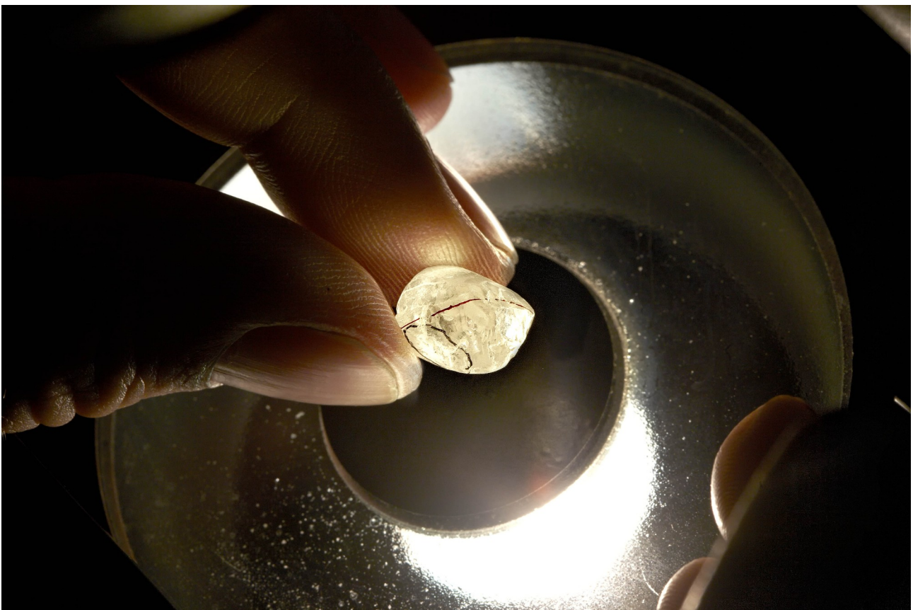
Planning van een ruwe diamant, het aanbrengen van inktlijnen, AMC Diamonds , 2011
