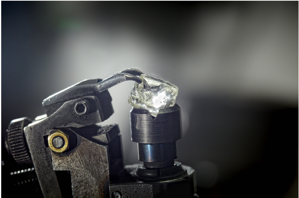
Diamant vastgezet in een klem voor de eerste stap van de diamantbewerking, het blokken, AMC Diamonds , 2011
