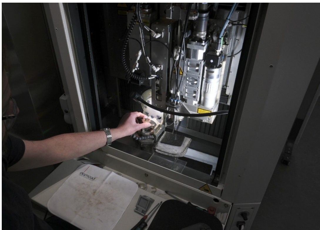
Synova 5-axis waterjet laser voor diamantbewerking, Diamcad , 2025
