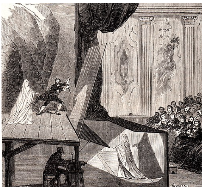
Afbeelding: Illustratie werking Pepper's Ghost-effect. © Pepper's Ghost in Le Monde Illustré (21 January 1865) door Bertrand | Publiek domein, via Wikimedia Commons
